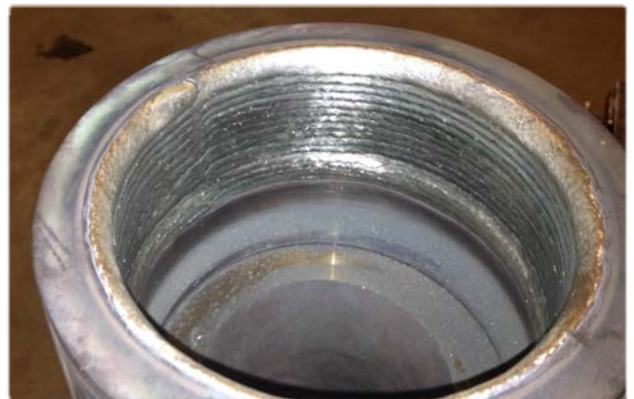
Boring opgelast Stellite 6
